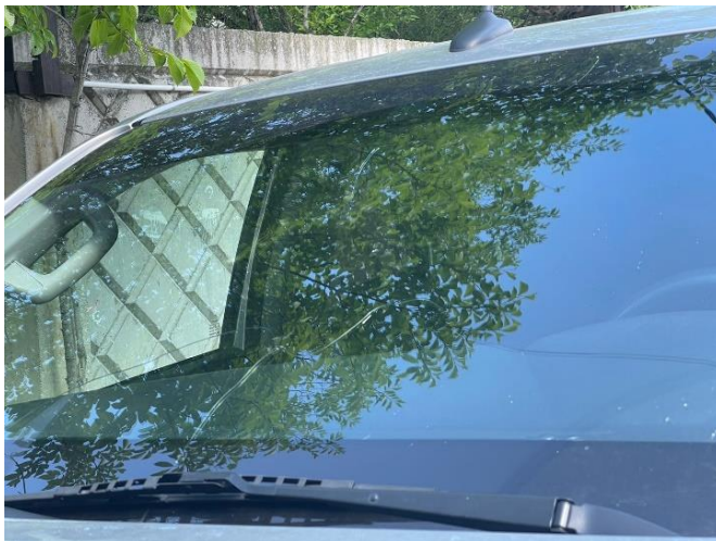
Трещина на лобовом стекле
